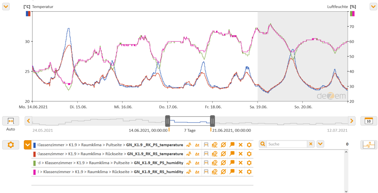
Abbildung 75: GN K1.9 Raumklima Temperatur und relative Luftfeuchte - Wochenverlauf
