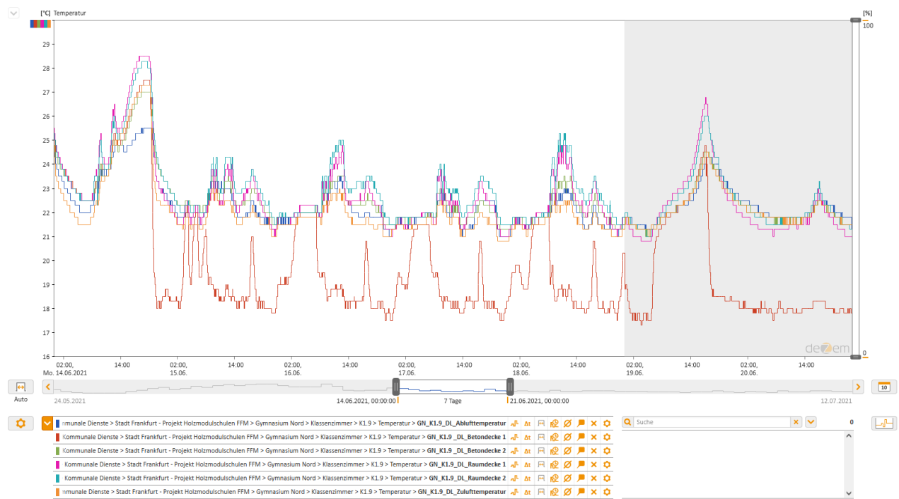
Abbildung 95: GN K1.9 Temperaturen Decke und Lüftung – Wochenverlauf
