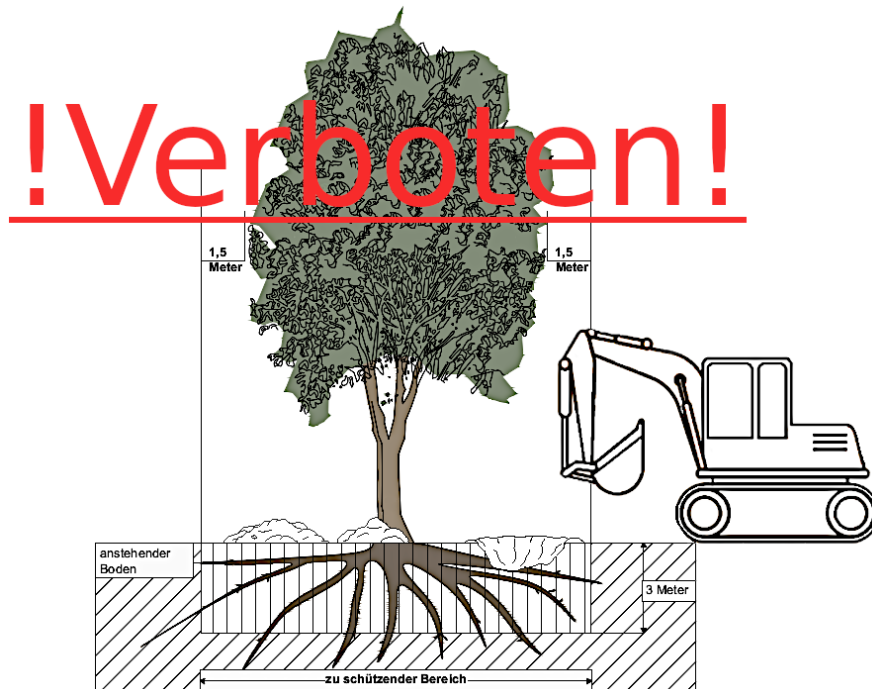
Abbildung 3: Abgrabungen und Aufschüttungen
