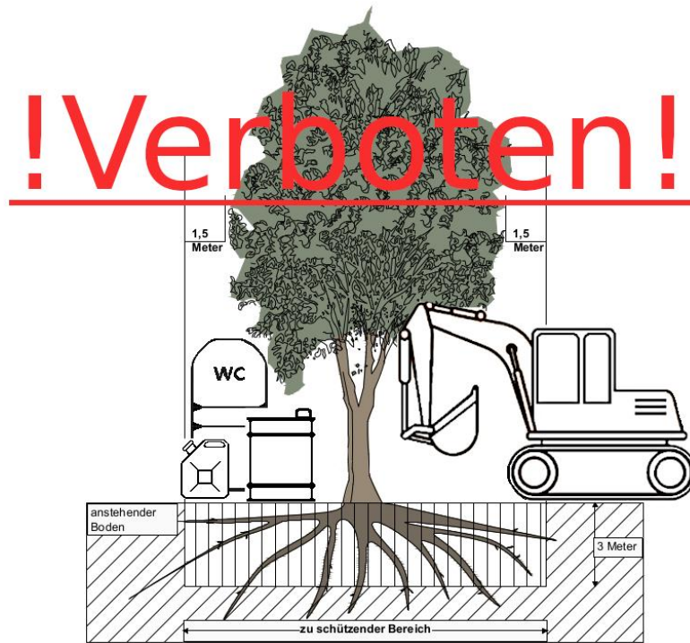
Abbildung 2: Baustelleneinrichtungen, Lagern und Befahren
