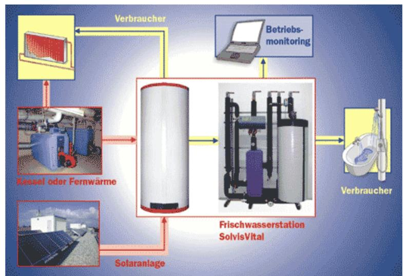
Systemdarstellung eines Pufferschichtspeichers mit einer Frischwasserstation.
