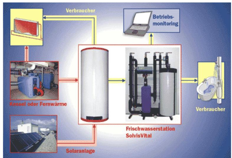
Systemdarstellung eines Pufferschichtspeichers mit einer Frischwasserstation.
