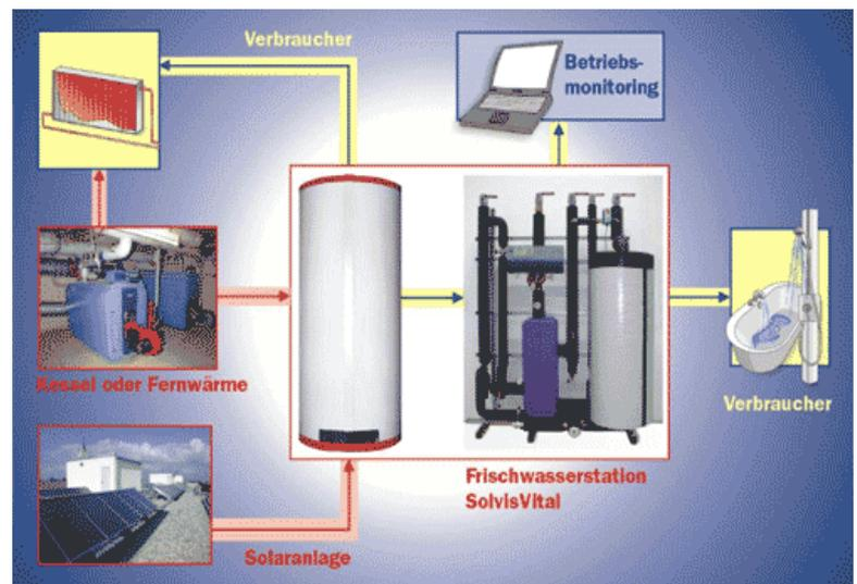
Systemdarstellung eines Pufferschichtspeichers mit einer Frischwasserstation.
