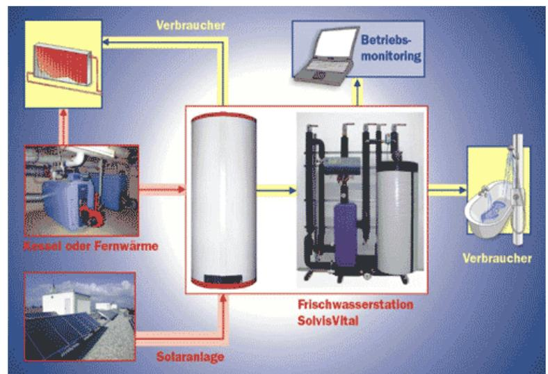
Systemdarstellung eines Pufferschichtspeichers mit einer Frischwasserstation.
