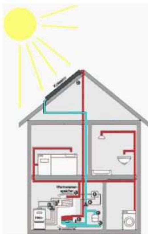
Die konventionelle Heizung gewährleistet über den Ladekreis, daß auch dann ausreichend warmes Wasser zur Verfügung steht, wenn die Solaranlage keine oder zu wenig Nutzenergie liefert. Solaranlagen lassen sich problemlos in die Gebäudetechnik integrieren. Damit ergänzt eine moderne thermische Solaranlage, die mit mindestens 20 Jahren die Lebensdauer eines Heizkessels übertrifft, die konventionelle Heiztechnik ideal.
