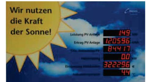
Die Anzeigentafel zeigt Leistung und Ertrag der PV-Anlage und die Energiekosteneinsparung insgesamt
