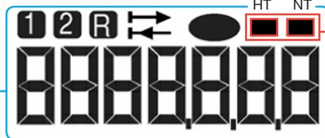
Leuchtet der linke der beiden Indikatoren auf, so ist Tarifregister 1 (aktueller Tarif HT) aktiviert, leuchtet hingegen der rechte Indikator auf, so ist Tarifregister 2 (aktueller Tarif NT) aktiviert. Nur einer der beiden Indikatoren kann jeweils angezeigt werden.
